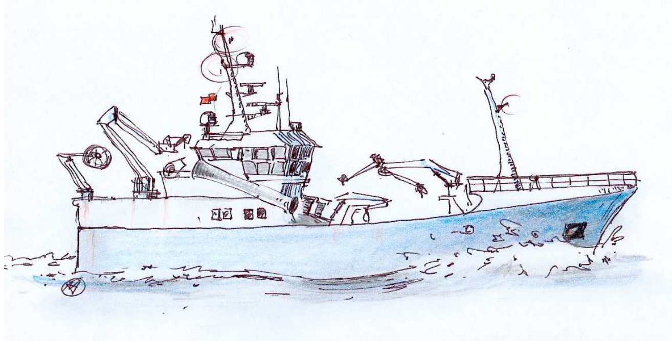
Figur 1: Et 44 meter snurrevadfartøy med to hovedmaster. Masten som er montert på toppen av styrhuset er signalmasten. Den er utstyrt med satellittkommunikasjonsutstyr, radarer, antenner og lanterner. En slik mastløsningen er svært vanlig på denne typen fartøy (snurrevad, linje, trål)
